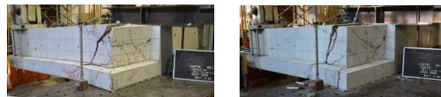
図-5 最終破壊状況
